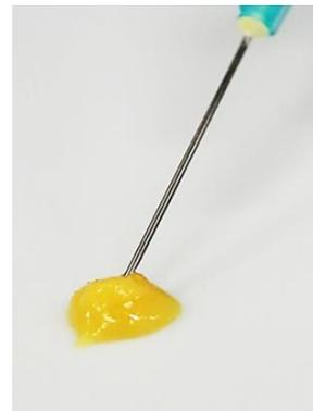
図：ドデシル化タラゼラチンを用いて調製した粒子（左）と生理食塩水を加えて調製した自己組織化粒子ゲル（右）。粒子に生理食塩水を加えることにより、注射器から注入可能なゲルとなる。
