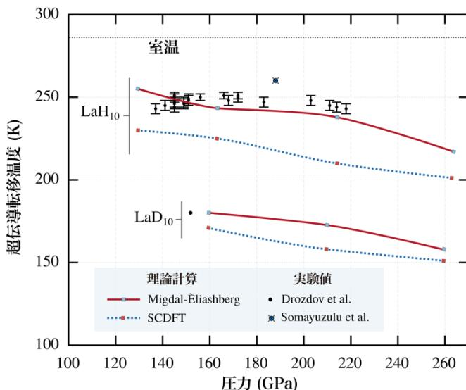
図 2. 立方晶  $\text{LaH}_{10}$  および  $\text{LaD}_{10}$  (D は重水素) における超伝導転移温度  $T_c$  とその圧力依存性。二つの異なる理論計算手法の結果と実験値を比較しています。
