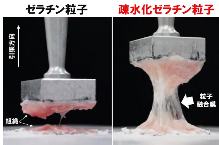
図3 接着試験後の疎水化ゼラチン粒子の様子
