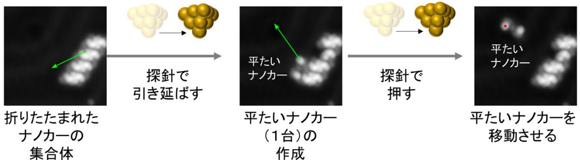
図2 小さく折りたたまれたナノカーから平たいナノカーを作成。隣接する分子群をアンカーにして探針 1) を使って、折りたたまれた分子を引き延ばします。探針 1) の方向は矢印のとおり。
