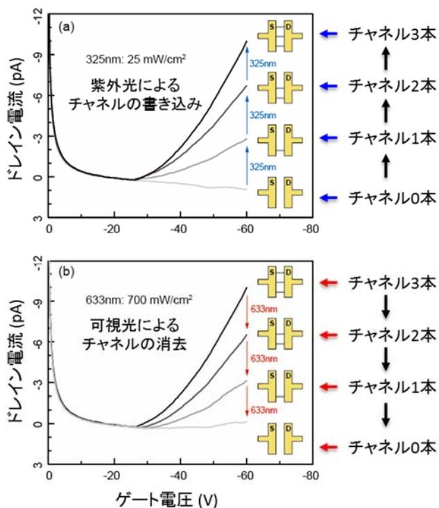
図2.(a) 紫外光を掃引して、一次元チャネルを書き込んだ場合のドレン電流変化。チャネルの数を最大 3 本まで並列接合している。0 本から 3 本まで増やしていくにつれ、ドレン電流が増加している。このような段階的に電流量を制御するためには、光照射強度を制御しても同様に可能である。(b) 可視光を掃引して、一次元チャネルを消去した場合のドレン電流変化。紫外光と全く同じ場所を掃引できるため、ドレン電流を段階的に元の通りに減少できている。
