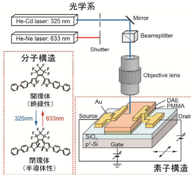
図1. 分子構造・素子構造・光照射系の模式図。分子はジアリールエテン中心骨格の両側にビフェニル基が取り付けられており、開環体では絶縁体、閉環体では半導体の性質を示す。まず開環体（絶縁体）の薄膜をSiO<sub>2</sub>/Si基板上に作製し、その両側にソース・ドレイン電極を取り付けた。Si基板がゲート電極、SiO<sub>2</sub>膜がゲート絶縁層としてはたらく。ここに紫外光（波長325nm）を掃引して、閉環体（半導体）に異性化したところだけ、トランジスタチャンネルとして電流が流れる。再度、可視光（波長633nm）を照射するとチャンネルは消去できる。
