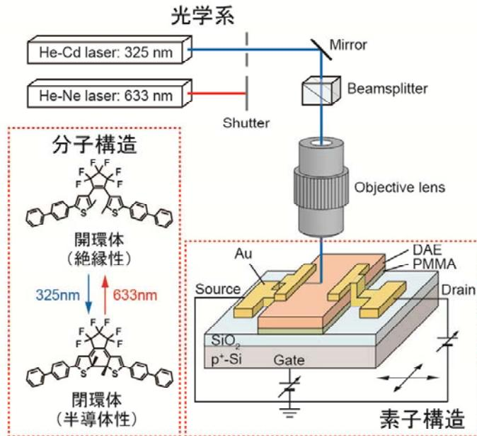
図1. 分子構造・素子構造・光照射系の模式図。分子はジアリールエテン中心骨格の両側にビフェニル基が取り付けられており、開環体では絶縁体、閉環体では半導体の性質を示す。まず開環体（絶縁体）の薄膜を  $\text{SiO}_2/\text{Si}$  基板上に作製し、その両側にソース・ドレイン電極を取り付けた。Si 基板がゲート電極、 $\text{SiO}_2$  膜がゲート絶縁層としてはたらく。ここに紫外光（波長 325nm）を掃引して、閉環体（半導体）に異性化したところだけ、トランジスタチャネルとして電流が流れる。再度、可視光（波長 633nm）を照射するとチャネルは消去できる。
