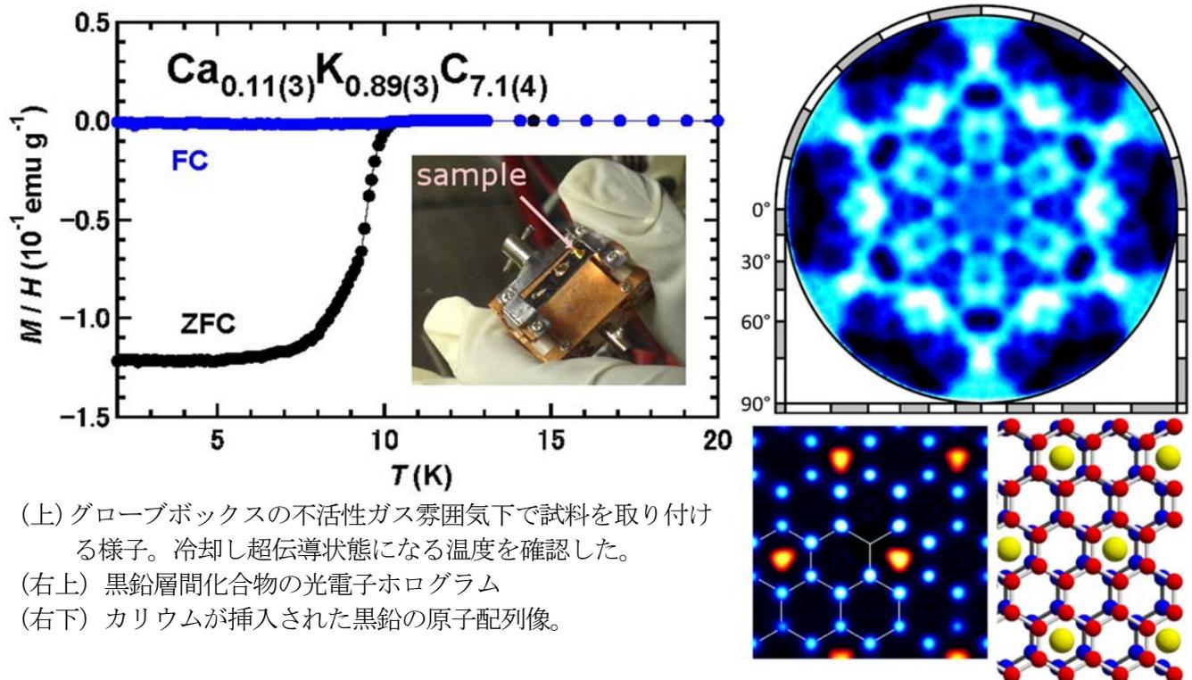
(上) グローブボックスの不活性ガス雰囲気下で試料を取り付ける様子。冷却し超伝導状態になる温度を確認した。
