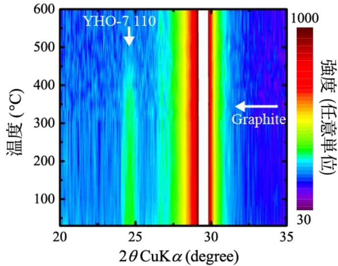
図 1. 結晶構造の温度変化
