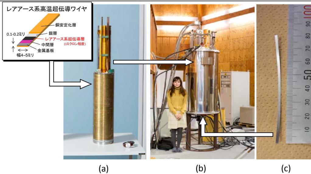
図 2 レアアース系高温超伝導ワイヤのコイルを組み込んだ 400MHz の NMR 装置
