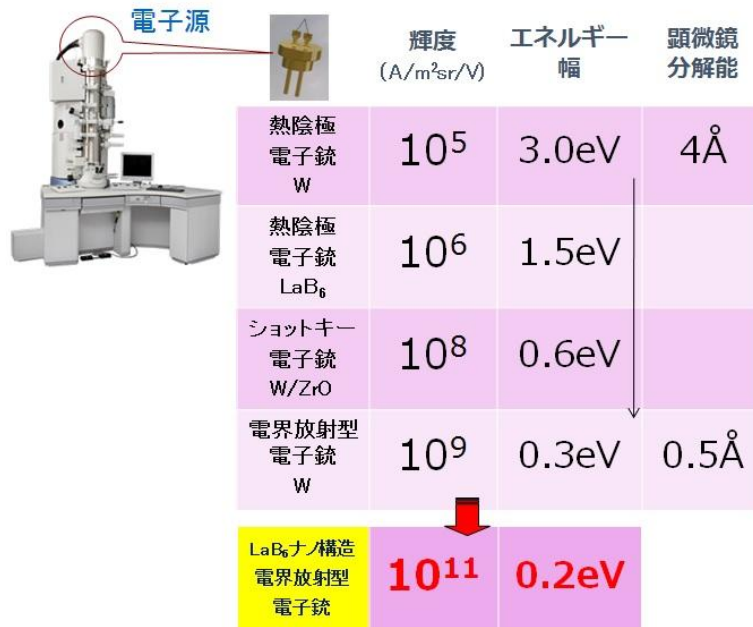
図1 従来の電子銃と今回開発した LaB 6 ナノワイヤ電界放射型電子銃の比較。従来型に比べて高輝度でエネルギー幅が 3 分の 2 の電子源を実現した。
