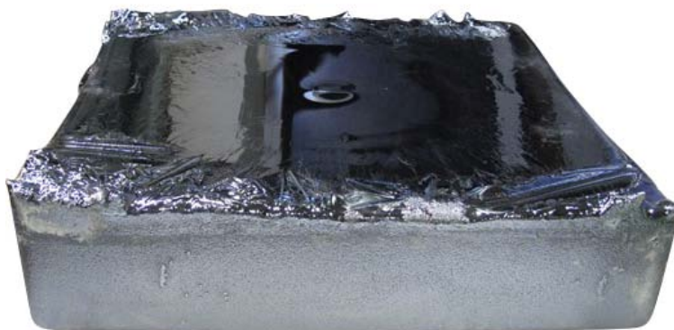
写真：新しい鑄造法で育成した50cm角のモノシリコンインゴット
