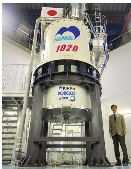
NIMSとJEOLをはじめとする研究チームが開発した1020MHz-NMR装置のうち超伝導磁石の部分。
