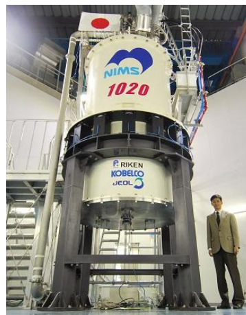
図 1：今回開発した 1020MHz-NMR 装置のうち超伝導磁石の部分。高さ約 5m、重さ約 15 トン。この中に高温超伝導体で作られたコイルが入っています。液体ヘリウムを使って冷却しています。
