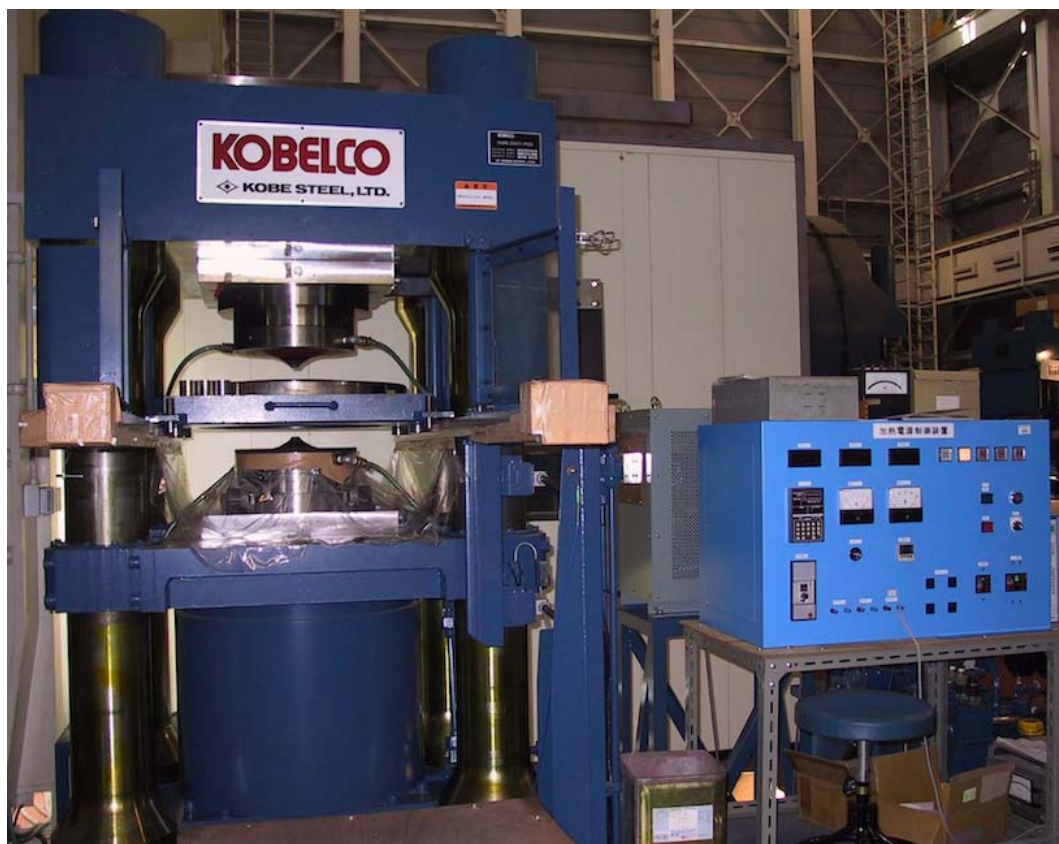
2000t ベルト型高温高圧プレス装置
