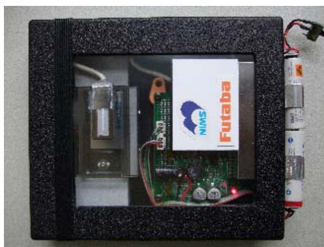
図 2 電池式遠紫外光源：単三電池 4 本で素子が動作している。 （左側の水平の青いラインが発光部分）
