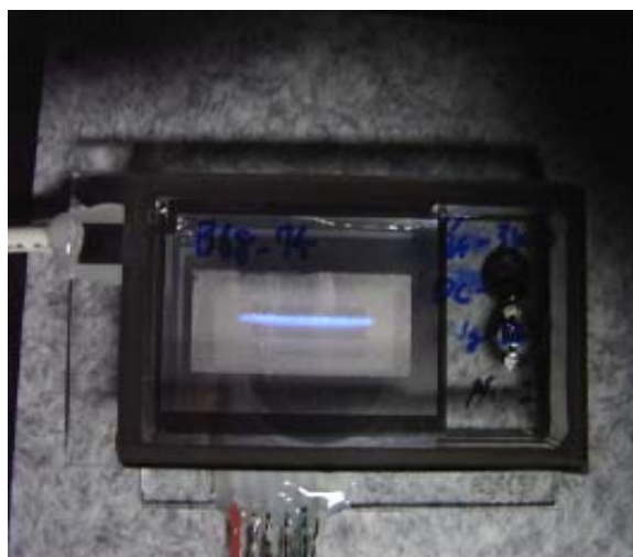
図 1-B 試作素子の動作時の写真（青白く光っている部分が発光領域～光が出ているところ）
