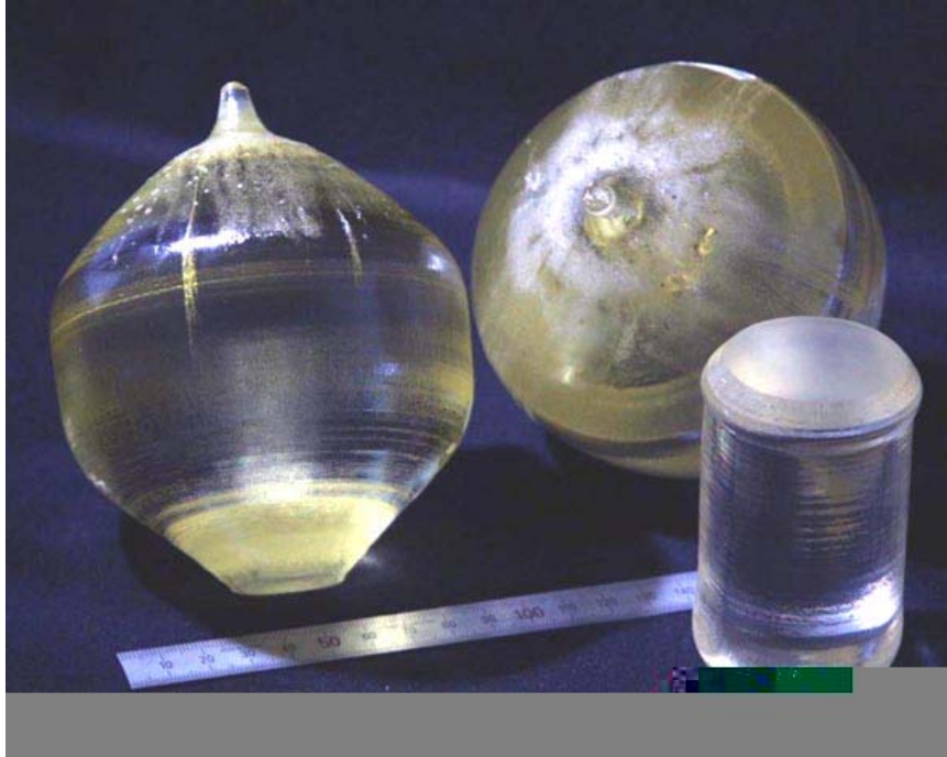
図1 物質・材料研究機構で開発した低欠陥タンタル酸リチウム単結晶。直径は最大4インチで、実用化のレベルに達している。
