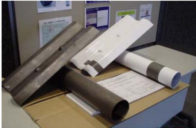
高リン含有鋼により作製したガードレール
