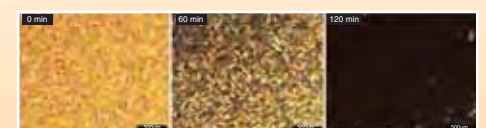
図2 5 テスラの磁場下における斜方晶液晶材料の磁気光学応答の時間変化。磁気光学偏光顕微鏡により測定。
