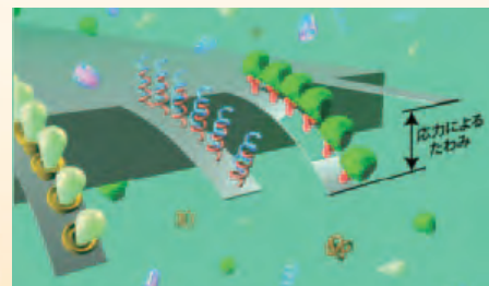
図1. ガス分子から生体分子まで、様々な試料をカンチレバーの配列(アレイ)によって測定している様子。検体分子吸着によって生じる「たわみ」をシグナルとして測定する。
