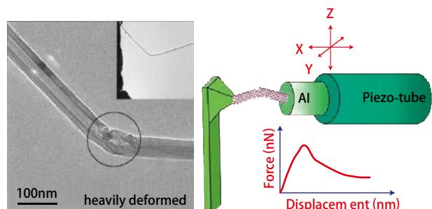
TEM内で計測された窒化ホウ素ナノチューブの機械特性
