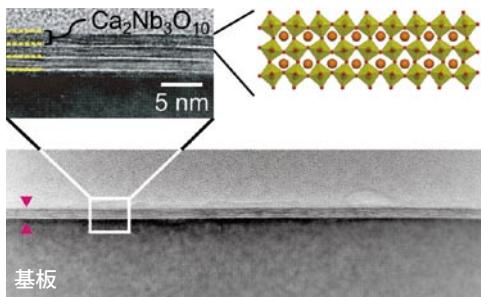
Ca<sub>2</sub>Nb<sub>3</sub>O<sub>10</sub>ナノシート 3層膜(断面TEM像)
