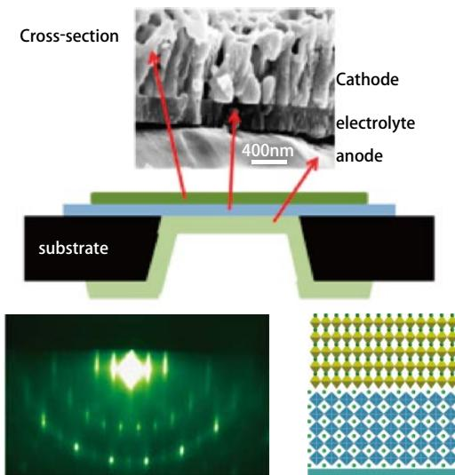
上：固体酸化物型燃料電池 下：リチウム電池用高配向電解質
