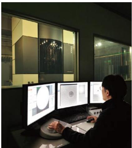
収差補正装置付電子顕微鏡(300kV)
