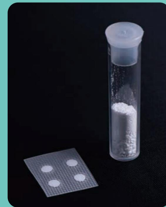
合成した粘土の粉体(右)とガス放出パッチ(左)。粘土の設計次第で、ガスの濃度と放出量をコントロールできる。
