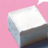
完成したエアロゲルを砕いて微粒子状にし、溶媒に溶かせば、断熱性のある塗料になる。
