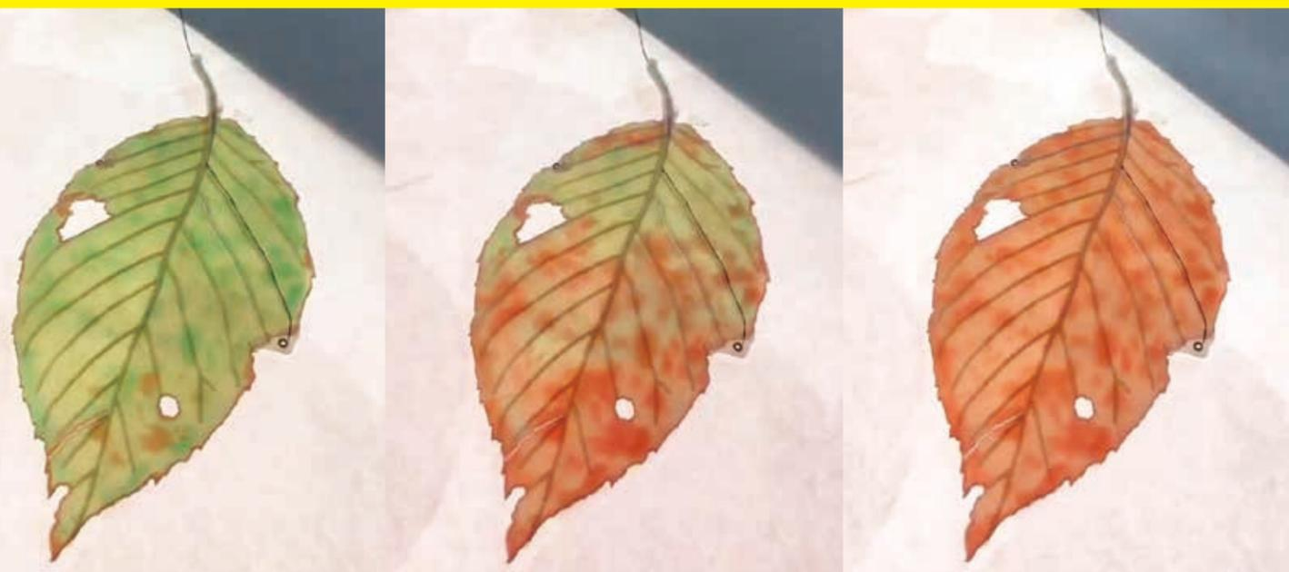
わずかな電気を流すだけで色がゆっくり変化していき、逆向きに電気を流すともとの色に。電気を切ると色ついた状態がキープできる。多摩美術大学、早稲田大学と共同で開発。
