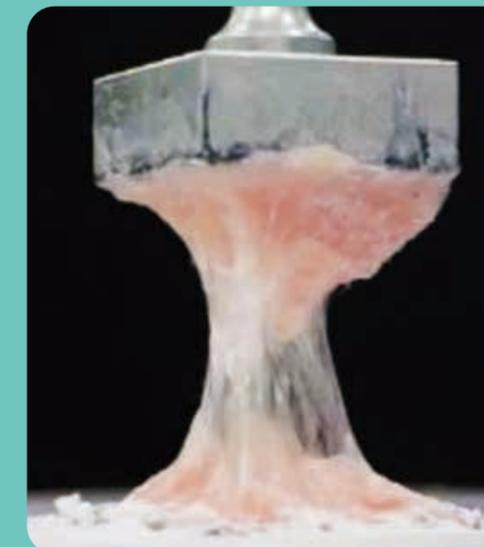
開発した被覆材料を使った接着試験の様子。
