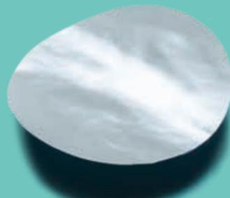
性能試験用に切りだしたフィルター。
