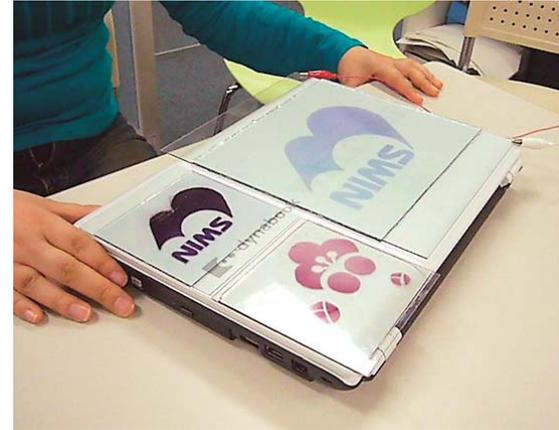
図3 有機/金属ハイブリッドポリマーを用いた固体表示デバイス
