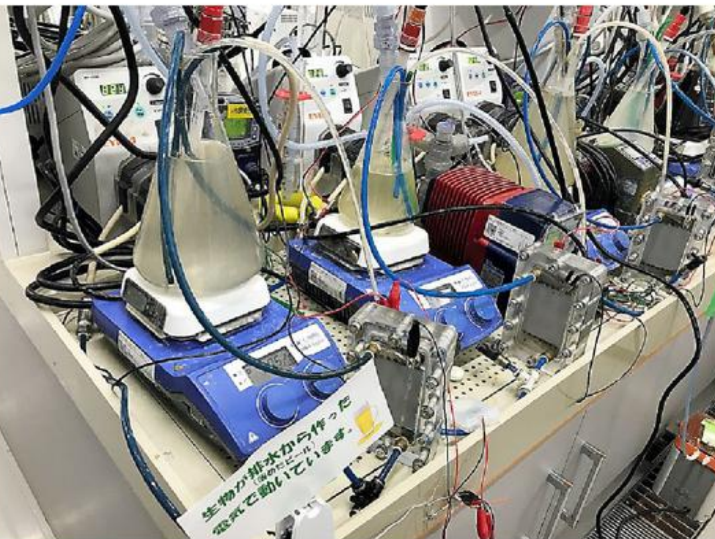
栗田工業が開発した微生物発電の実験装置。縦10センチ、横5センチの電極の上に生えた細菌が約10 8 ワットの電力をつくる＝東京都昭島市、同社提供
