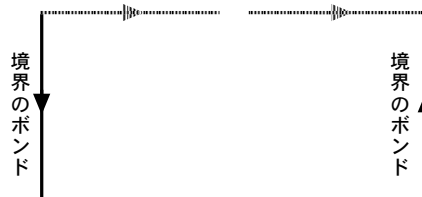
図 72 A_2, A_4 の境界条件における垂直方向の境界をまたぐ実線バンドと破線バンドの対
