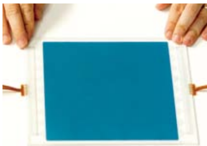
新EC材料（メタロ超分子ポリマー）を用いた調光デバイスのサンプル
