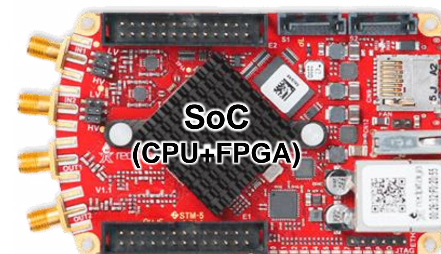
STEMlab 125-14 107×60 mm, 90 g (電池除く) 4 W (計測中)
