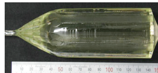
図2 TSLAG大型単結晶。大きなファラデー回転角と高い透明性を示すため、高出力レーザー加工機の光源保護に使われる光アイソレーター用として優れた性能を発揮する。
