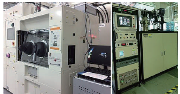
図2 窒化物半導体及びダイヤモンド半導体の気相成長装置の外観フォト
