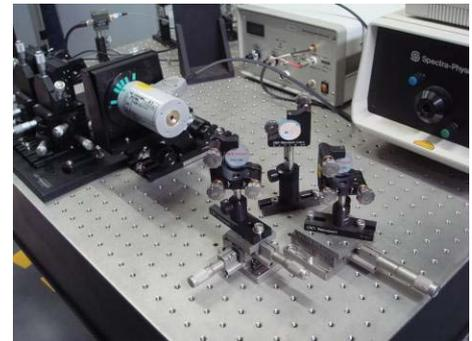
図2 EO素子を用いた励起光変調システム。
