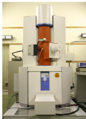
図1 走査透過電子顕微鏡の外観図
