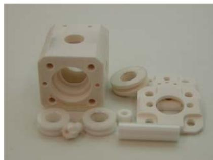
図2. セラミック製MAS装置
