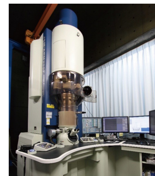
図1: 実働環境対応電子線ホログラフィー電子顕微鏡
