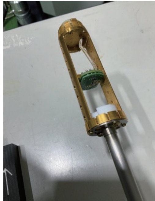
図2: 電気抵抗用試料回転プローブ(左)、光ファイバープローブ(右)
