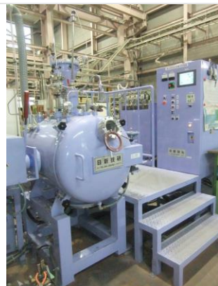
5kg 高周波誘導真空溶解炉
