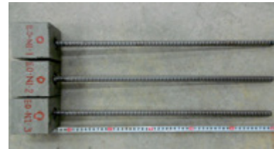
3) 腐食試験 ⇒引抜試験
