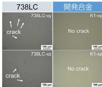
商用Ni基超合金(Inconel 738)と比較し、3D造形中のき裂発生を大幅に抑制できる新合金を開発
