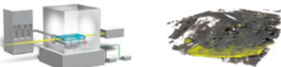
SPring-8に設置された全電池のオペランドX線CTイメージング装置と、不安全性現象後の電池構造変化
