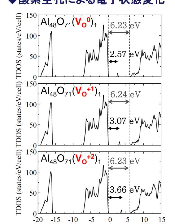
バンドギャップ中に空孔局在準位が出現. 空孔準位のエネルギー位置は、空孔の荷 電状態q = 0, +1, +2の順に上昇.
