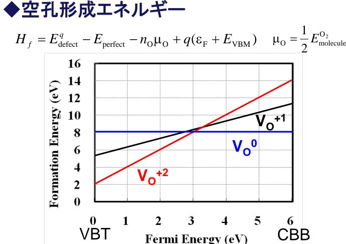
フェルミエネルギー位置がギャップ中央(~3eV)より 価電子帯側のとき $V_0^{+2}$ が、伝導帯側のとき $V_0^0$ が最 安定荷電状態.
