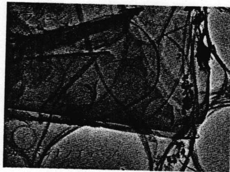
図4 グラフェン表面に接着したカーボンナノチューブの透過型電子顕微鏡写真
