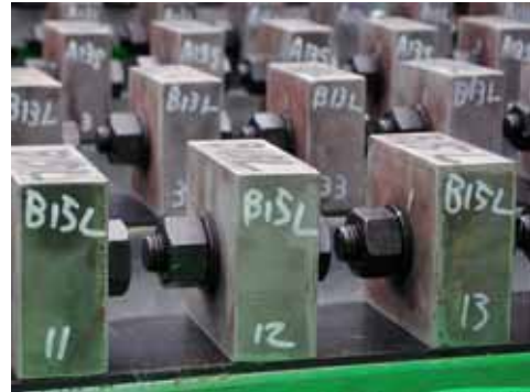
図1 締結したボルトの暴露試験体 (第二期 建築研究所 つくば)
