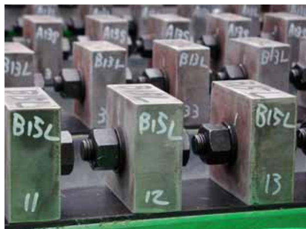
図2 第2期共研暴露試験の試験体 設置状況(建築研究所;つくば市)
