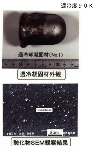
図1 過冷却凝固サンプル(300g)と内部に微細分散したTi系酸化物粒子
