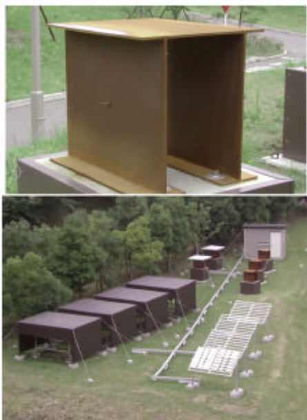
図1 高精度大気腐食試験場（下）と構造物模擬試験体（上）の外観
