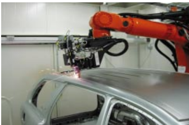
図1 自動車ボディ（車体）の屋根部にYAGレーザー溶接を適用（写真は、Volvo Cars Corporation提供）
