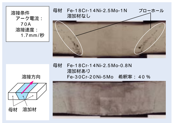
図12 高N添加オーステナイト相ステンレス鋼のブローホール抑制法
