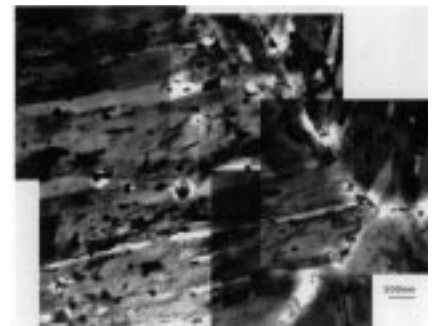
図11 金属間化合物強化型 12Ni-9Co-5Mo-TiAl-B 鋼 (マルエージタイプ鋼) の700、100MPa試験後の電子顕微鏡組織
