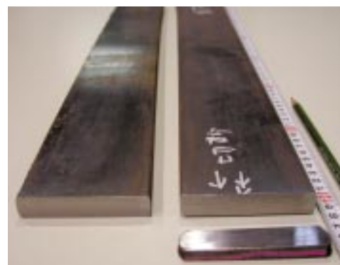
図10 作製された板厚18mm、板幅80mm、長さ約2mの厚板。結晶粒径 0.5\sim 0.6\mu\text{m} の微細粒組織を持つ
