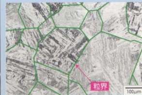
粒内結晶はラスマルテンサイト組織で、方位の異なるバケット組織が存在
