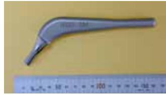
図6 ニッケルフリー高窒素鋼による人工関節用ステムの試作例
