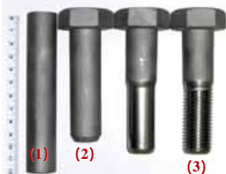
プロトタイプ鋼での超高力ボルト成形 プロセス(M22)
