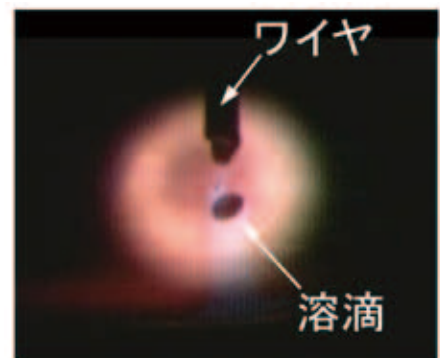
図2 安定なワイヤ溶融と溶滴移行により安定なクリーンMIG溶接を実現
