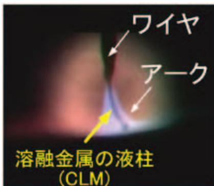
図1 ワイヤ先端に溶融金属液柱が生じる不安定なクリーンMIG溶接
