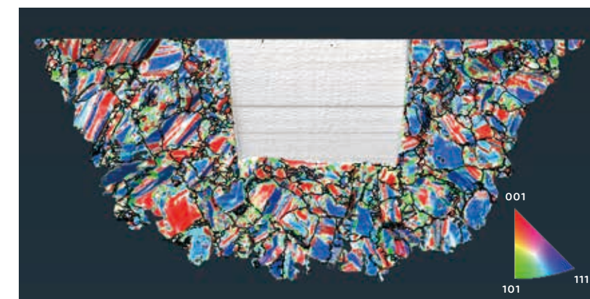
亀裂の成長経路における結晶方位の解析画像 亀裂は主に、青で表示された「すべり面」と呼ばれる結晶面(111面)を通過していることが明らかになった。
