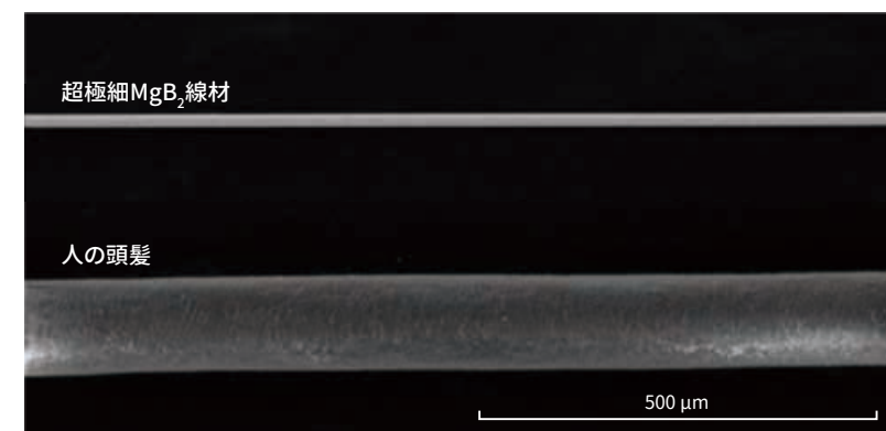
超極細MgB 2 線材と人の頭髪との比較 人の頭髪が直径80 ~ 100μmであるのに対し、MgB 2 超伝導線の直径はわずか15μm。超伝導モーターのエネルギー効率において重要な指標となる「交流損失」は、「ヒステリシス損失」「結合損失」「渦電流損失」で構成されるが、超伝導線材を細くすればするほど「ヒステリシス損失」が抑えられ、線材を複数本撚って使うことで「結合損失」が大幅に低減できる。
