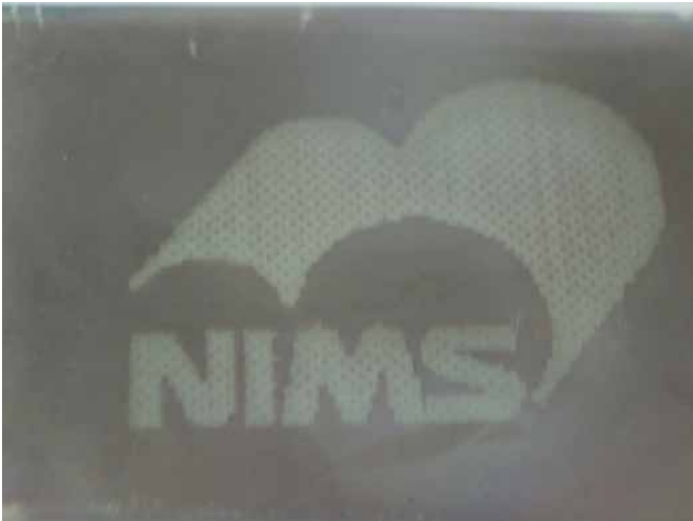
図1 無加熱ガラス基板上に作製した二酸化チタン薄膜の光触媒効果を利用して浮き上がった物質・材料研究機構のロゴマーク
